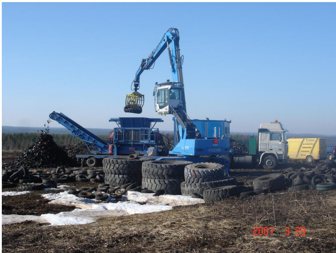
Kuva 2. Rengasrouheen leikkausprosessi työmaaolosuhteissa.
